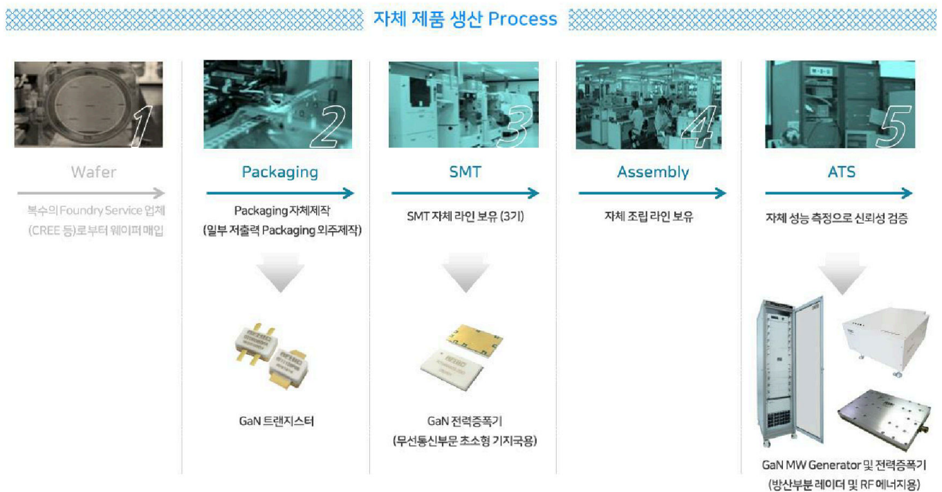
그림 7. RFHIC의 자체 제품 생산 Process
