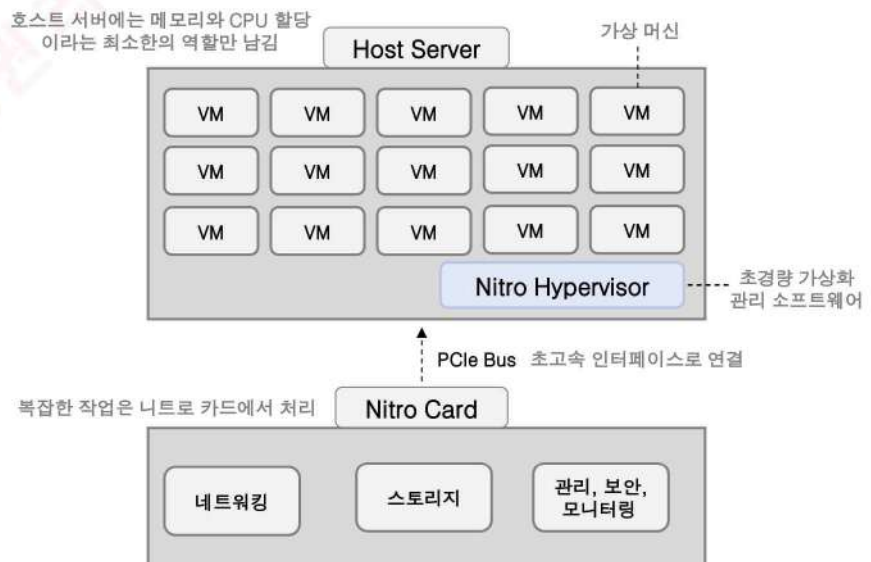
[그림 40] AWS의 Nitro 시스템: 자체 하드웨어를 사용함으로써 장비 구매 비용 절감
