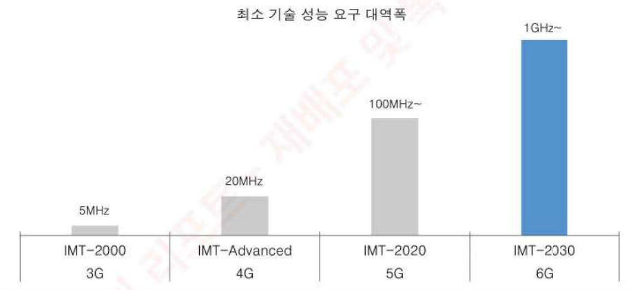
[그림 67] 빠른 속도를 위한 고주파뿐 아니라, 트래픽 수용을 위한 넓은 대역폭도 요구
